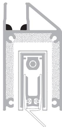
**Befestigungsarten:** Silikonkleber. Zuvor Klebeflächen reinigen nach Kleber-Hersteller-Anleitung.
