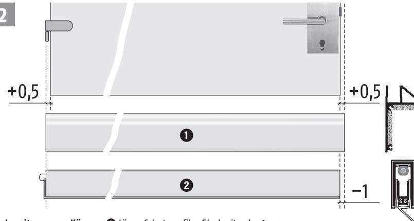
**Vorbereitung zum Kürzen:** ① Länge Schutzprofil = Glasbreite plus 1 mm;
