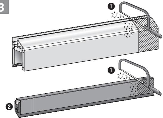
① Schutzprofil / Dichtung kürzen, Späne entfernen;
