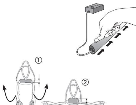
**Hinweis:** Bei EPE040/105 und EPE040/081 müssen die Schenkel um 90 Grad hochgeklappt werden ① vor Einziehen des Schaltstreifens, um die Schaltkammer anzuheben und die Montage zu unterstützen ②.
