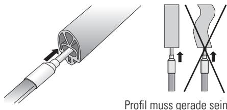
Beim Einziehen des Schaltstreifens in das Gummiprofil dürfen keine Gleitmittel wie Wasser, Talk, Öle, Fette oder Silikonspray verwendet werden. Nur so kann sich die später aufgetragene Dichtmasse mit dem Gummiprofil verbinden und die Schaltkammer abdichten.
