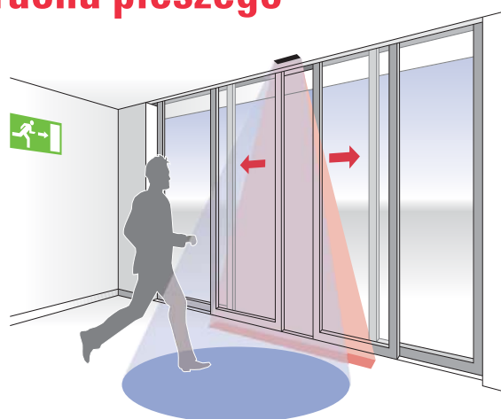
Czujniki do dróg ewakuacyjnych PrimeTec A ES.SM – gdy są podłączone do systemu zabezpieczonego przed awariami.
