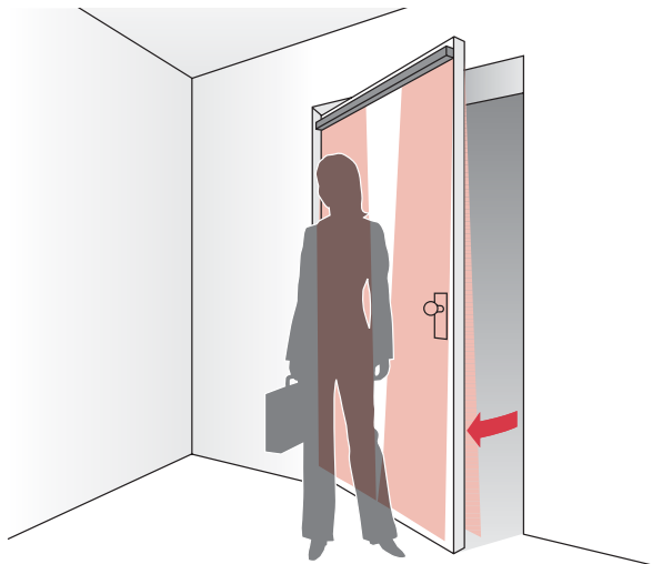
Możliwość zabezpieczenia drzwi rozwiernych czujnikami Bircher Reglomat.
